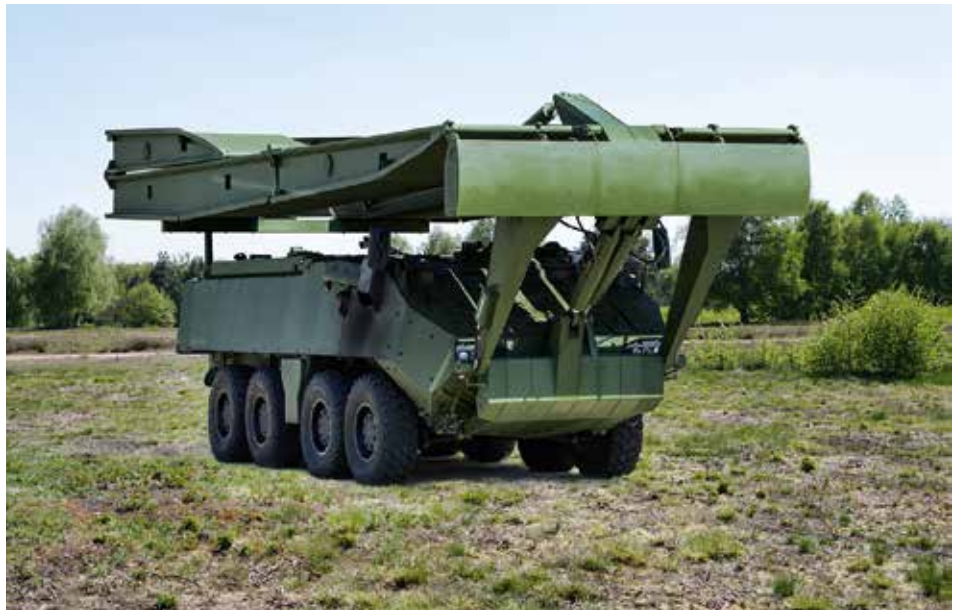
Die Variable Folding Bridge (VFB) als neue Generation modularer Brücken für mittlere Kräfte kann flexibel an unterschiedliche Rad- und Kettenfahrzeuge ohne Integrationsaufwand adaptiert werden
